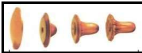
Fig 3 - 20 – Mecanismo de colapso do Disco Balístico
