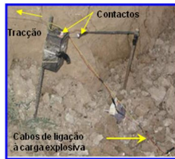
Figura 3 - 8 – Disparador improvisado, de tracção
